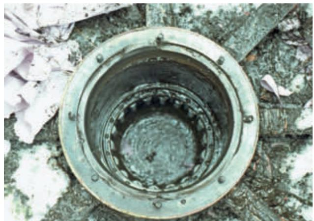
Abb. 7: Nach dem Reinigen der gesamten Lagerschale konnte man den unzerstörten Käfig des unteren Seilscheibenlagers samt den Lagerrollen erkennen.
