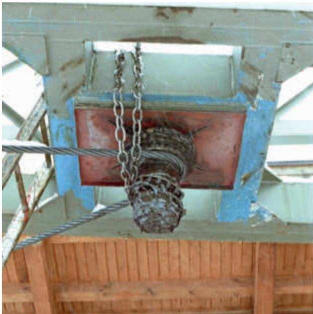
Abb. 1: Das Förderseil verhängte sich an der Achse der Umlenkseilscheibe und wurde nach dem Unfall mit einer Kette gesichert.
