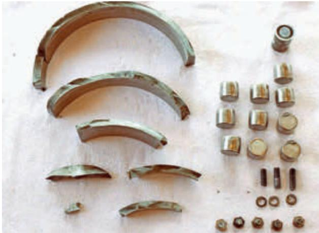
Abb. 8: die geputzten Teile des oberen Seilscheibenlagers: links die Bruchstücke des äußeren Lagerrings, rechts die Lagerrollen und gebrochenen Befestigungsschrauben des Lagerdeckels.
