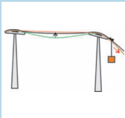
Fig. 2 : Oscillation du câble tracteur due à une modification de la traction exercée par le véhicule au passage sur les pylônes
