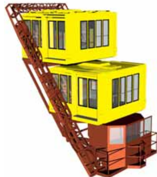
Cabines d'ascenseur pour la Tour Eiffel
