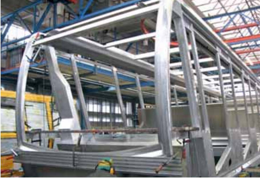
Une des deux cabines (90+1) destinées au funiculaire de Resciesa dans le hall de production
