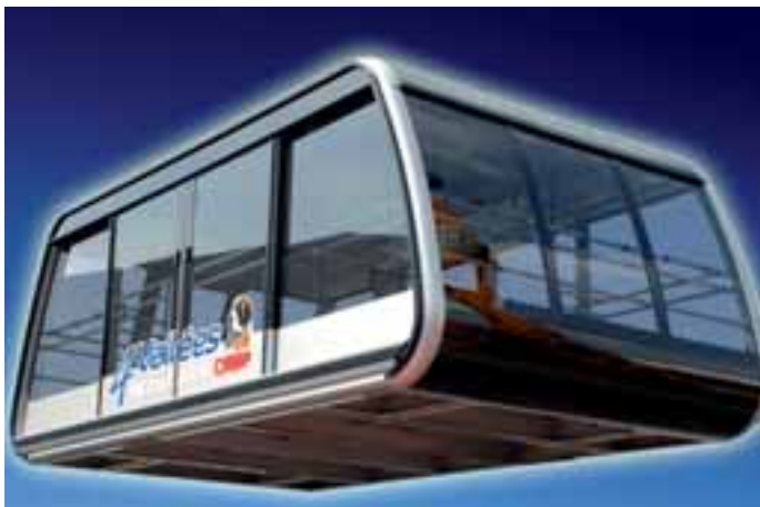
Depuis 2009, deux nouvelles cabines KRONOS 125 places + 1 cabinier sont en service sur le téléphérique de Verbier (Les 4 Vallées). Cette année, CWA livrera deux autres cabines KRONOS (45+1) pour le téléphérique de Mont-Fort II.
