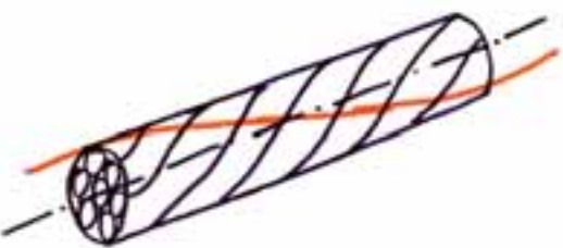
Les fils cassés se trouvaient à la surface du câble le long d'une spirale allongée
