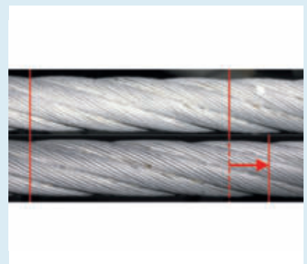
Fig. 7 : Modification de la longueur du pas d'hélice avant et après passage d'une pince, par suite d'un mauvais alignement des éléments de guidage du câble.
