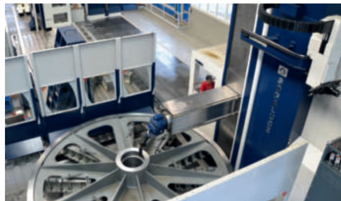
Usinage grand format : le tournage d'une poulie motrice de 6 m de diamètre.
