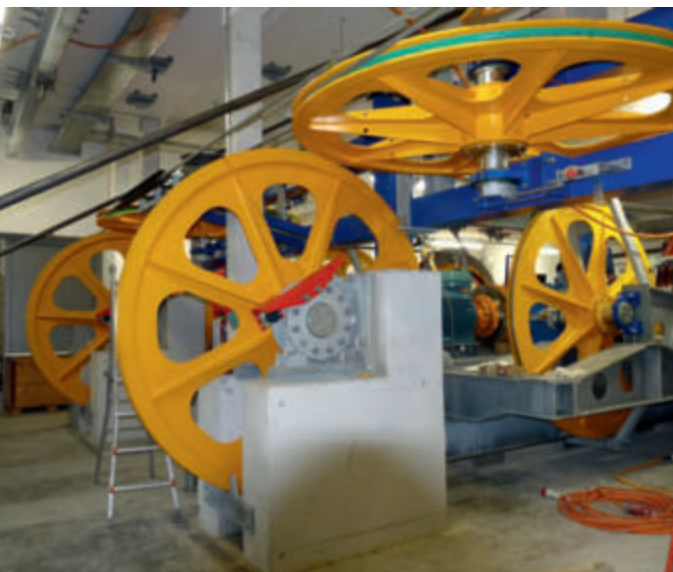
Le guidage complexe du câble tracteur dans la salle des machines exige deux poulies motrices à double gorge, deux contre-poulies et six poulies de renvoi.
